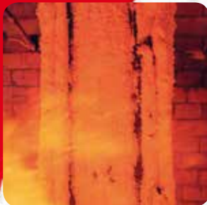
Trave in acciaio protetta dalla vernice intumescente
